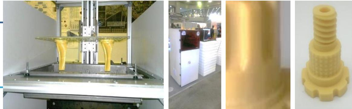
Установка для изготовления сложных прототипов деталей методом послойного отвердевания полимеров
