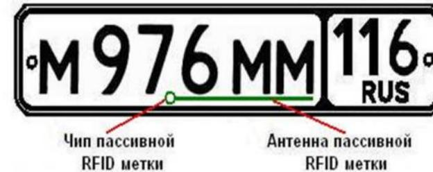
Номерной знак с меткой и антенным устройством
